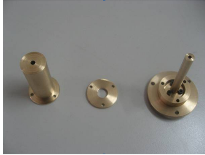
Şekil 6: Pirinçten üretilmiş oyuk katot prototipi
